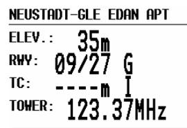
Dieses Bild zeigt die Landebahnbefestigung an, C bedeutet Asphalt oder Beton und G bedeutet Gras.
