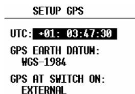
Das GPS-Earth-Datum ist als WGS 84 einprogrammiert und lässt sich nicht verstellen. Die Information GPS AT SWITCH ON informiert über die Benutzung der eingebauten GPS-Empfänger (Internal) oder NMEA-gesteuerten Gerät (external). Die Eingabe ist schon ab Werk richtig eingegeben.
