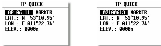
Einmal verläuft die Nennung nach Datum und Uhrzeit (z.B. 02.10.06:13) und das zweite Mal als AP und Uhrzeit (siehe SETUP nach Password Kapitel TP).
